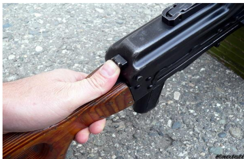
Рисунок 5 – відкривання кришки ствольної коробки кулемета.
